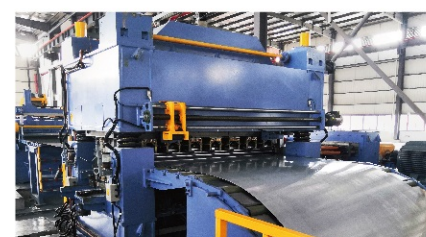
○ 六重式校平机 6-layer Type Leveller
